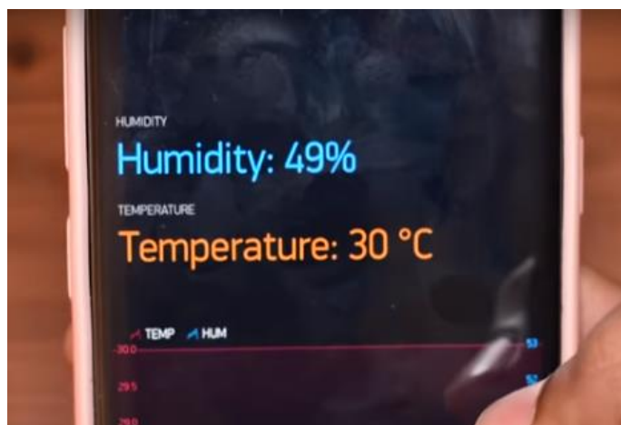
Gambar 3.4. Pengujian aplikasi blynk pada android
