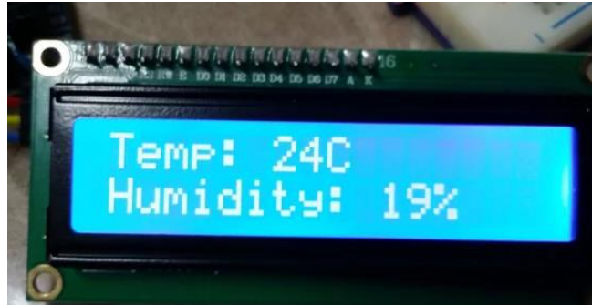
Gambar 3.1. Tampilan hasil pengujian modul sensor DHT11 pada LCD
