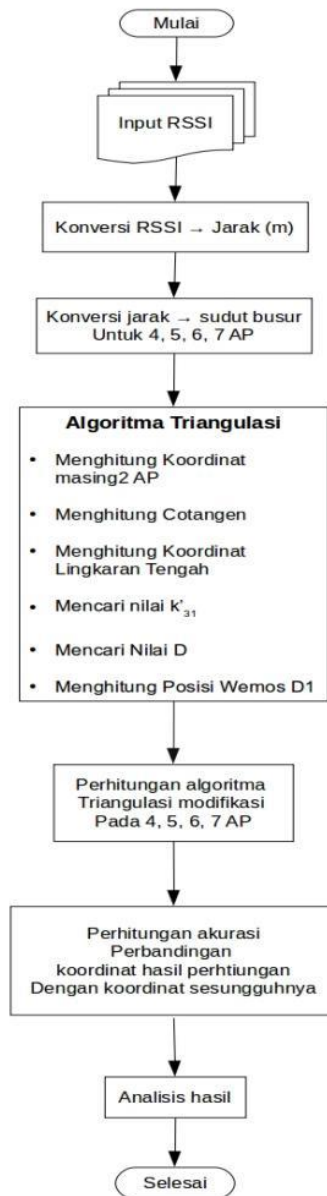
Gambar 7. Diagram pengujian menggunakan metode Triangulasis
