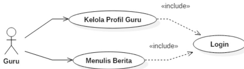
Gambar 5. Use-case diagram dari user level guru
